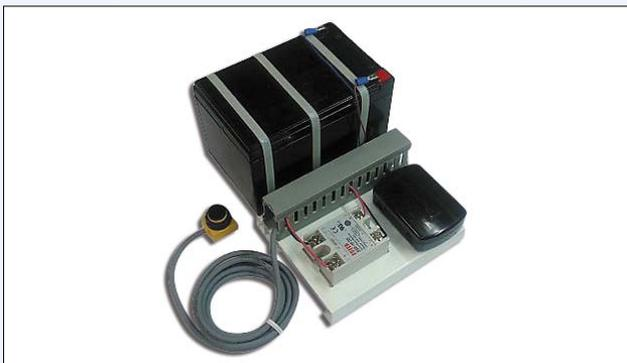
Рис. 1. Испытуемый блок сбора и передачи данных СМК
