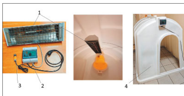
Рис. 8. Действующий образец ИК-обогревателя линейного типа для телят в индивидуальном домике: 1 – ИК-обогреватель; 2 – щит автоматического управления; 3 – датчик положения животного
