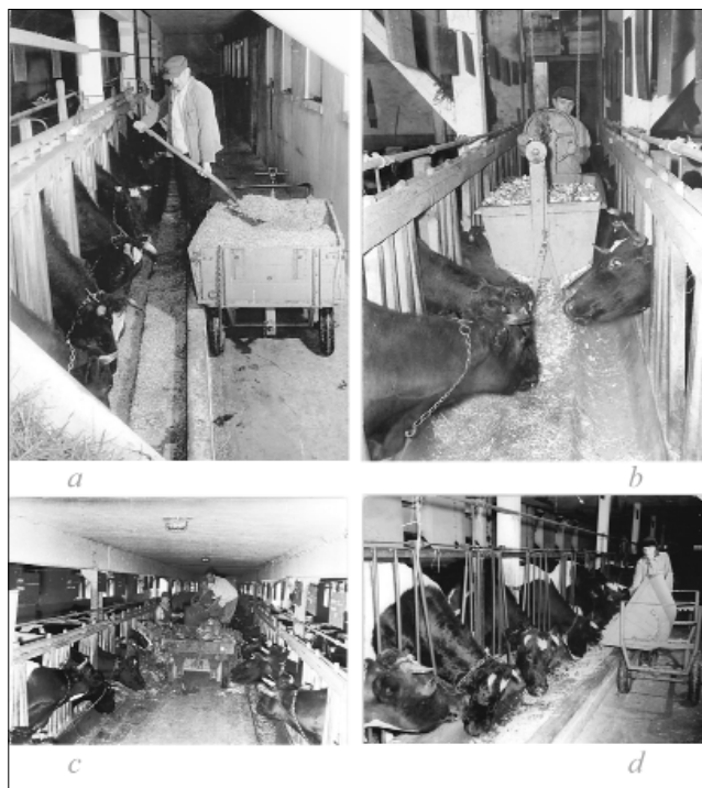
Рис. 3. Ранний этап комплексной механизации раздачи кормового компонента для КРС ( https://commons.wikimedia.org ): а – передвижной транспортер (1957 г.); б – кормораздаточная лента (1957 г.); в – электрокар с передвижной тележкой (1958 г.); д – кормораздатчик (1960 г.) Fig. 3. Early stage of integrated mechanization in cattle feeding systems: а – mobile conveyor (1957); б – feed conveyor belt (1957); в – electric cart with a movable trolley (1958); д – feed dispenser (1960). Source: https://commons.wikimedia.org
