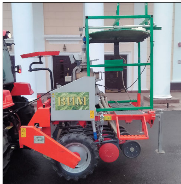
Рис. 6. Сеялка селекционная роботизированная ССР-3 Fig. 6. Robotic selection seed drill SSR-3
