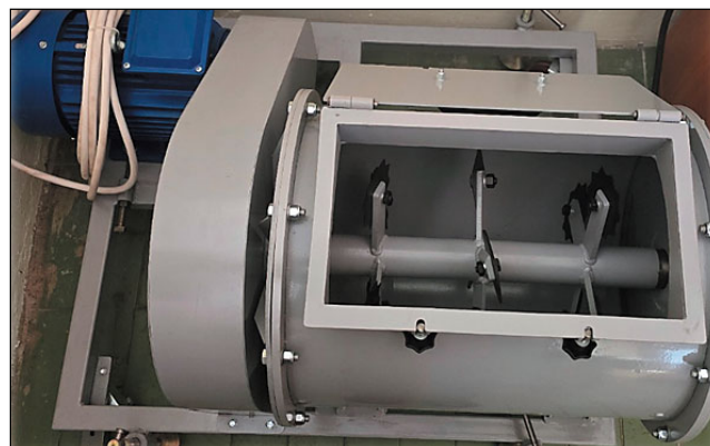
Рис. 5. Установка для ускоренных испытаний рабочих органов на коррозионно-механический износ
