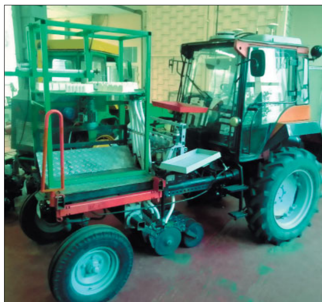
Рис. 5. Роботизированная селекционная сеялка СССР-1 для первого этапа работ
