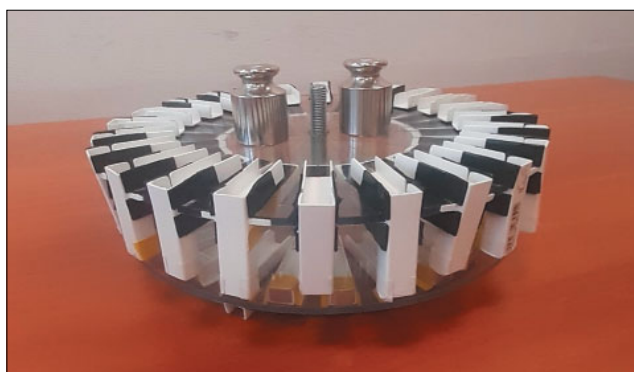
Рис. 6. Общий вид вращающейся левитирующей модели доильной платформы карусельного типа под нагрузкой
