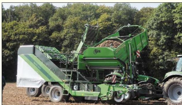
Рис. 12. Прицепной картофелеуборочный комбайн Spirit 8200 фирмы AVR в работе
