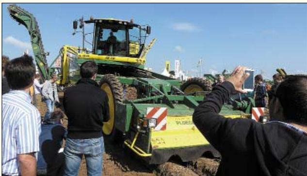
Рис. 14. Самоходный копатель-погрузчик AR 4W фирмы Ploeger в работе на показе
