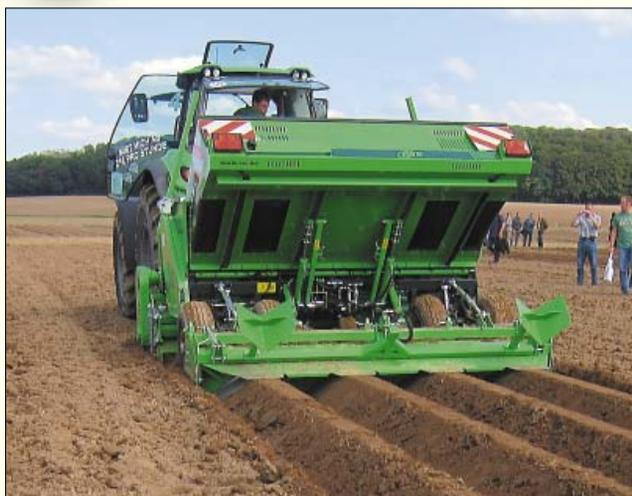
Рис. 9. Комбинированный агрегат для подготовки почвы и посадки картофеля
