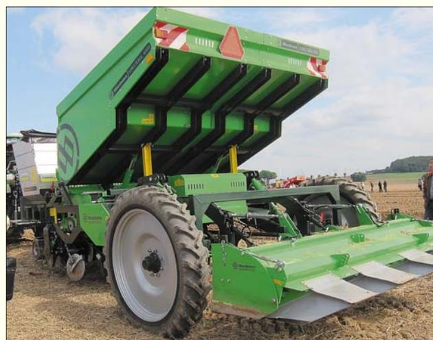
Рис. 8. Картофелесажалка с тросовым высаживающим аппаратом
