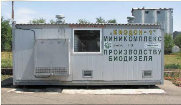
Рис. 1. Модульная установка для производства биодизельного топлива
