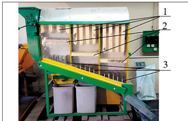
*Рис. 1. Расположения ускорителей и рассекателей в пневмоканалах макетного образца: 1 – колонковый ускоритель; 2 – батарейный ускоритель; 3 – рассекатели*
