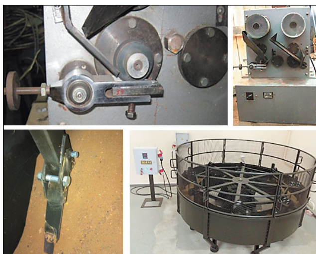
Рис. 1. Исследование процесса изнашивания образца: сверху на стенде ИМ-01; внизу на круговом стенде Fig. 1. Examination of the sample wear process at the IM-01 test stand (top) and at the circular test stand (bottom)
