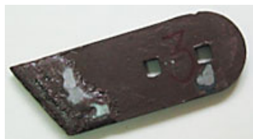
Рис. 2. Вид упрочненного наплавочным твердым сплавом испытуемого долота лемеха плуга ЛМВ-00У
