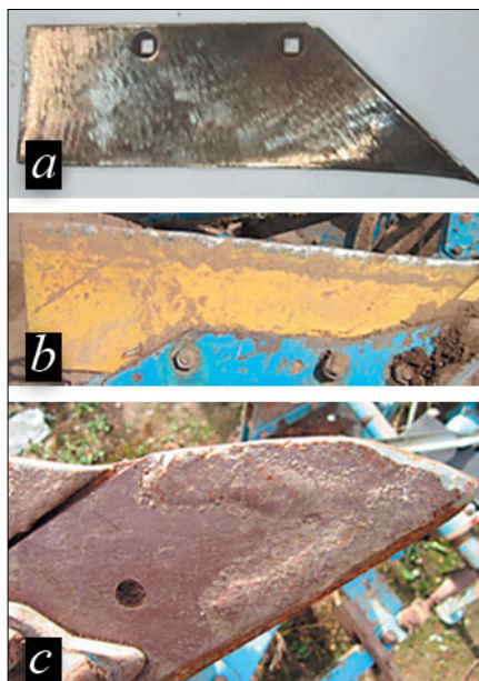
Рис. 3. Вид изношенного (после наработки 35 га): а – серийного импортного изготовленного из высокопрочной титансодержащей стали лемеха плуга фирмы «Лемкен» (ФРГ); б – импортозамещающего лемеха плуга фирмы «Лемкен», наплавленного опытным твердым сплавом ПР-ФБЗХ; с – импортозамещающего долота плуга фирмы «Лемкен», наплавленного опытным твердым сплавом ПР-ФБЗХ
