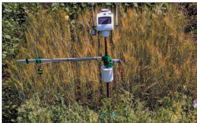
Рис. 3. Полевые испытания интеллектуальной сенсорной станции
