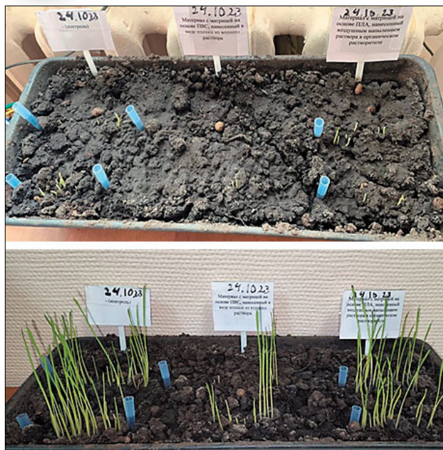
Рис. 3. Появление ростков на 9-е сутки (сверху) и прорастание пшеницы на 11-е сутки (внизу) из образцов колосьев (слева направо): контроль; завернутые в ПВС; с напылением ПЛА
