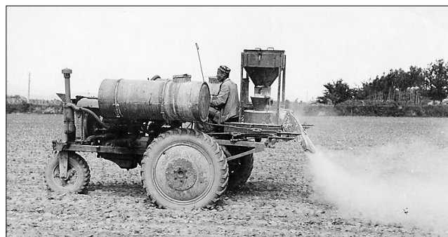
Опыливатель-опрыскиватель ОУН-4, агрегатированный с трактором «Универсал-4» (1950-е годы) The OUN-4 duster and sprayer aggregated with the Universal-4 tractor (1950s)
