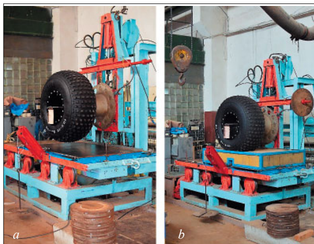
Рис. 3. Определение углов увода шины сверхнизкого давления на твердом (а) и грунтовом (б) опорном основании
