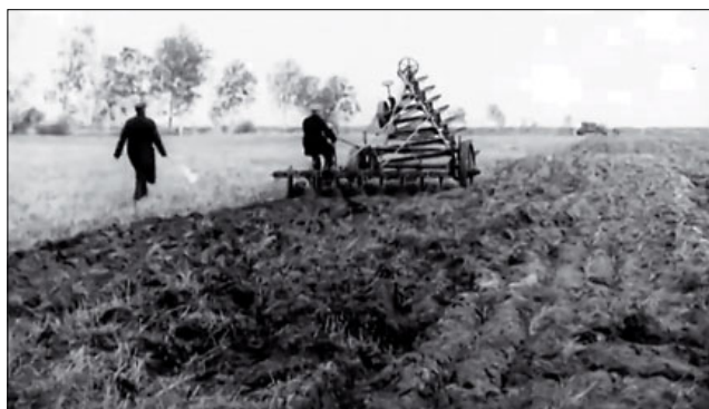
Рис. 2. Электротрактор системы А.И. Дидебулидзе на базе колесного трактора «Фордзон»
