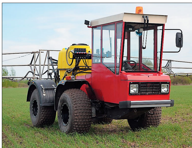
Рис. 1. МЭС-600 с шинами сверхнизкого давления 1020x420-18 модели Бел-79 при испытаниях
