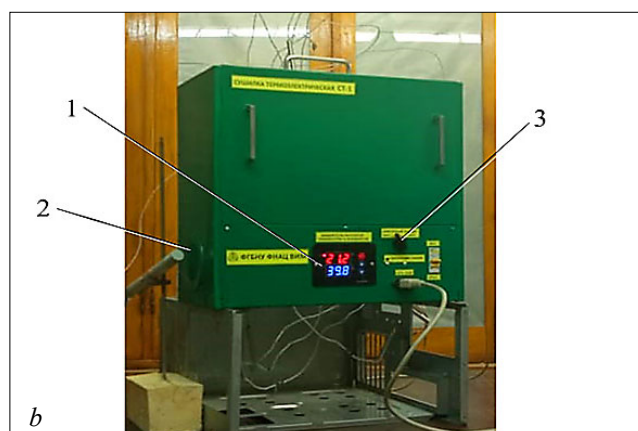
Рис. 2. Схема размещения датчиков температуры T1-T6 и влажности воздуха \varphi_{a1} , \varphi_{a2} в сушильной камере (а); общий вид лабораторного образца термоэлектрической сушильной установки (б): 1 – измеритель-регулятор температуры и влажности; 2 – отверстие для выхода отработанного сушильного агента; 3 – регулятор положения заслонки приточного воздуха
