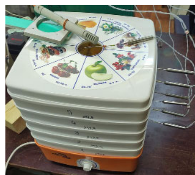
Рис. 3. Конвективная сушильная установка «РОТОР СШ-002» с датчиками температуры и влажности Fig. 3. Convective dryer ROTOR SH-002 with temperature and humidity sensors
