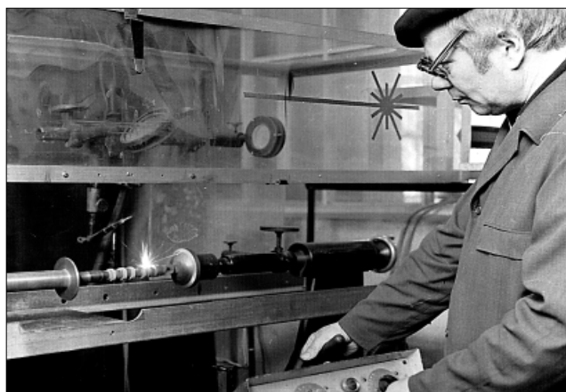
Рис. 3. Лазерное термоупрочнение деталей
