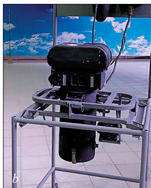
Рис. 3. Советские аэрофотоаппараты 1930-х годов: а – «АФА-33/75»; б – «НАФА-3с/50». Экспозиция Центрального музея Военно-Воздушных Сил РФ. Фото из архива авторов
