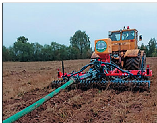
Рис. 5. Комбинированный агрегат для глубокого внутрипочвенного внесения жидких органических удобрений и посева сидеральных культур
