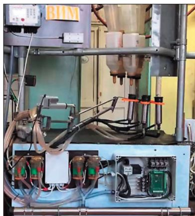
Рис. 6. Автоматизированный доильный модуль с интеллектуальным почетвертным управлением процессом доения для залов «елочка», «карусель» с внутренним доением (2019 г.)
