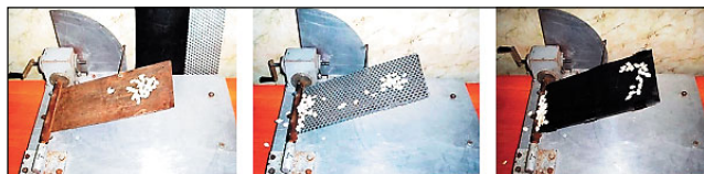
Рис. 4. Скольжение семян (слева-направо): по шлифованной стали, перфорированному стальному решетку, резине
