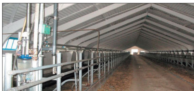
Рис. 4. Доильные установки с молокопроводом из нержавеющей стали УДМ-100-200 для привязного содержания (2001 г.)
