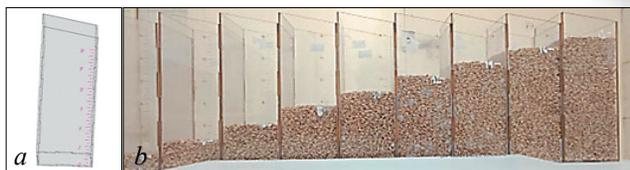
Рис. 2. 3D-модель проботборника (а) и набор проботборников со слоем зерна от 2 до 18 см (б)
