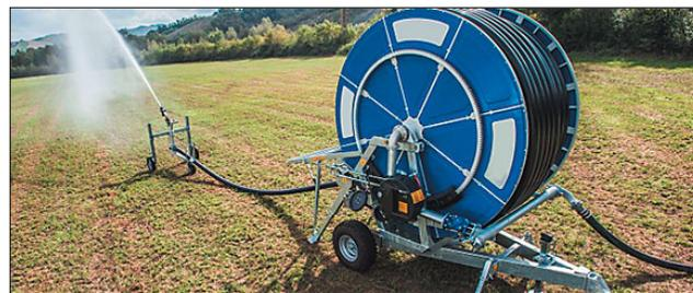
Рис. 5. Дождевальная машина барабанного типа
