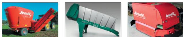
Рис. 2. Технические устройства для реализации Системы (слева направо): мобильный смеситель-раздатчик кормов с дополнительным транспортером; бункер-накопитель; колесный роботизированный кормораздатчик
