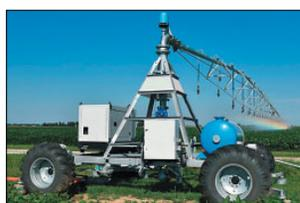
Рис. 3. Широкозахватная дождевальная машина фронтального типа
