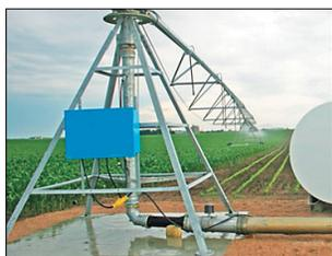
Рис. 1. Широкозахватная дождевальная машина кругового типа
