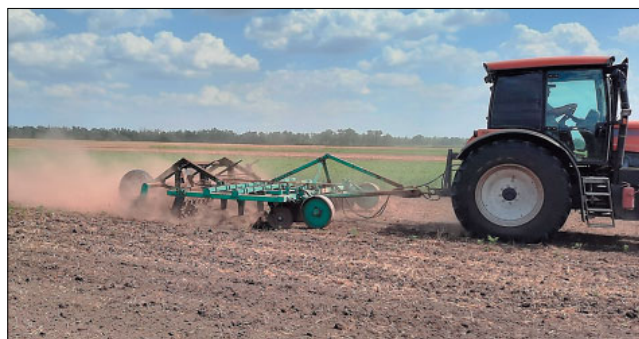
Рис. 1. Подготовка почвы комбинированным агрегатом КУМ-4 Fig. 1. Pre-sowing tillage using the combined unit KUM-4
