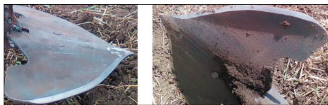
Рис. 1. Рабочий орган для мелкой обработки почвы на основе бионического формообразования
