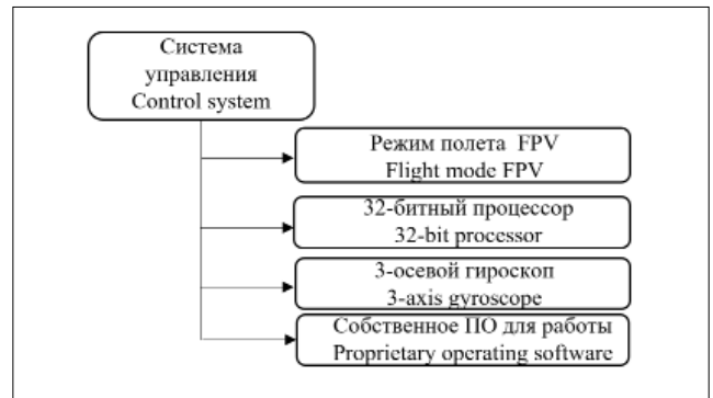
Рис. 17. Система управления CopterControl 3D Fig. 17. CopterControl 3D control system
