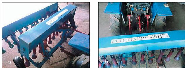
Рис. 2. Опытный образец сеялки для подсева травосмесей в агрегате с мини-трактором *Feng Shou 180*: а – вид справа; б – вид сзади
