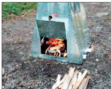
Рис. 5. Узел загрузки топлива
