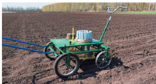
Рис. 2. Экспериментальный образец однорядной сеялки для посева колосьями на испытаниях
