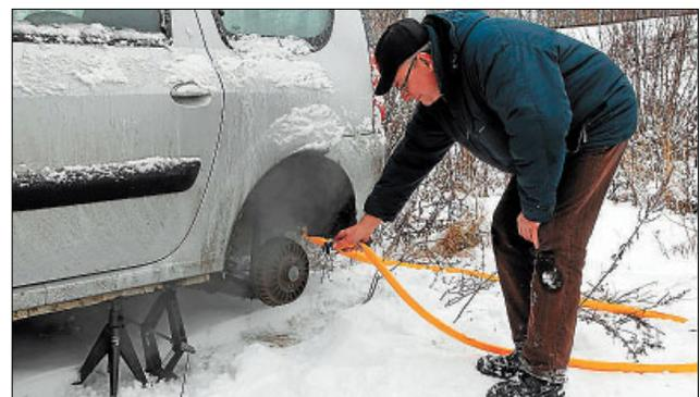
Рис. 3. Разморозка тормозных барабанов
