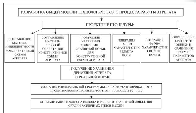
Рис. 7. Алгоритм создания системы автоматизированного проектирования широкозахватных почвообрабатывающих агрегатов с многосекционными орудиями
