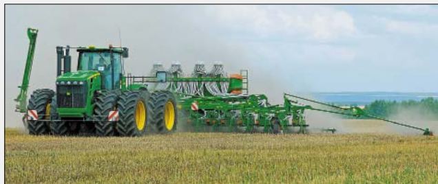
Рис. 2. Высокопроизводительная сеялка Primera DMC 12000
