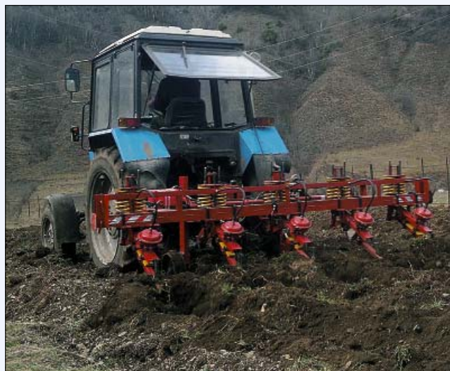
Рис. 4. Общий вид адаптивного энергосберегающего пропашного культиватора в процессе нарезки гребней в горах на каменистом участке
