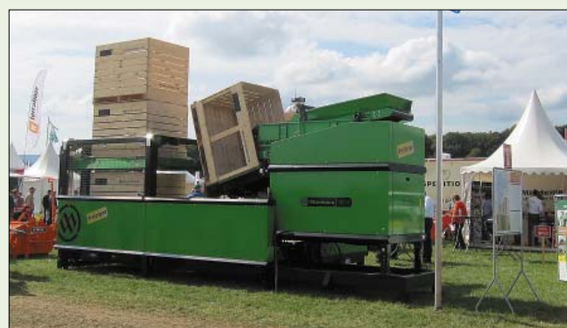
Рис. 5. Установка для затаривания евроконтейнеров
