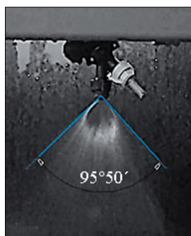
Рис. 4. Измерение угла распыла с применением программы Компас-3D
