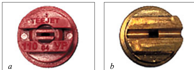
Рис. 2. Внешний вид образцов для испытания: а – полимерный распылитель TeeJet; б – спроектированный распылитель, изготовленный из бронзы
