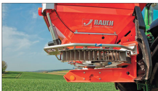
Рис. 3. Система Telimat T25 от компании Rauch (видны ограничители для равномерного внесения удобрений на узких участках поля и клиньях)
