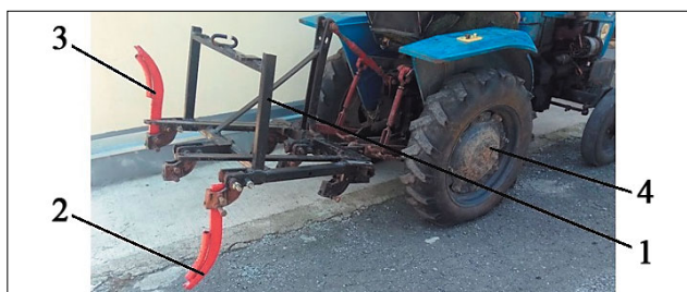
Рис. 3. Лабораторный образец агрегата для щелевания деградированных горных лугов и пастбищ на базе мини-трактора: 1 – рама агрегата; 2 – рабочий орган щелереза в рабочем состоянии; 3 – рабочий орган щелереза в транспортном состоянии; 4 – мини-трактор Feng Shou 180
