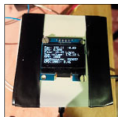
Рис. 4. Прототип устройства во время стендовых испытаний изношенного шестеренного насоса Fig. 4. A device prototype used during the bench tests of a worn gear pump
