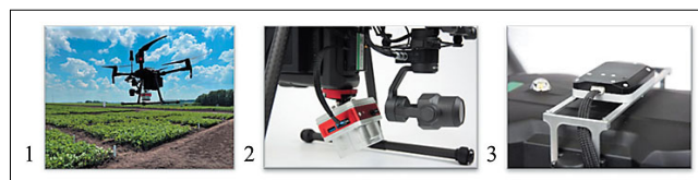
Рис. 1. Подвес для мультиспектральной камеры MicaSense Altum на БВС DJI Matrice 200 v2, разработанный сотрудниками ФНАЦ ВИМ: 1 – общий вид; 2 – крепление мультиспектральной камеры; 3 – крепление датчика освещенности Fig. 1. Gimbal for installing the MicaSense Altum multispectral camera on the DJI Matrice 200 v2 UAV, developed by the staff at the Federal Scientific Agroengineering Center VIM: 1 – general view; 2 – fastening of the multispectral camera; 3 – light sensor mount
