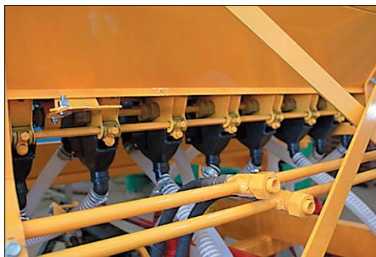
Рис. 2. Лоток-делитель потока семян и удобрений от высевяющих аппаратов к сошнику на сеялке СКП-2,1
