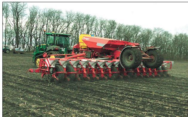
Рис. Сеялка точного высева *Optima TFmaxi* в агрегате с трактором *John Deere 8310RT*
