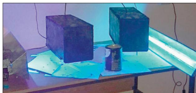
Рис. 6. Эксперимент по ускорению полимеризации эмали
