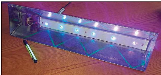
Рис. 4. Эритемный УФ-облучатель на основе светодиодов
