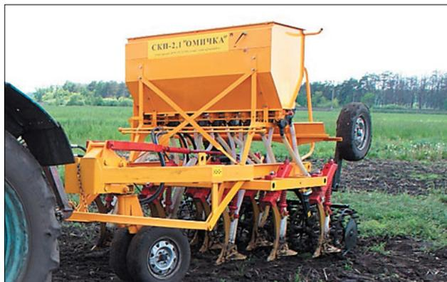
Рис. 3. Сеялка СКП-2,1М с экспериментальными сошниками
