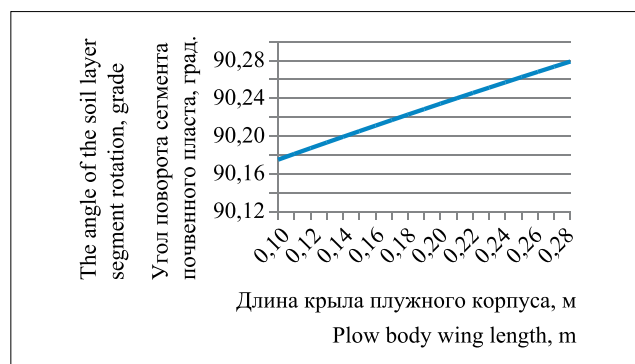
Рис. 5. Зависимость угла поворота сегмента почвенного пласта от длины крыла плужного корпуса
