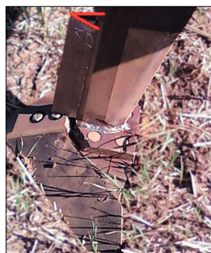
Рис. 1. Угол заточки стойки рабочих органов
