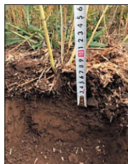
Рис. 4. Определение толщины задерненного слоя
