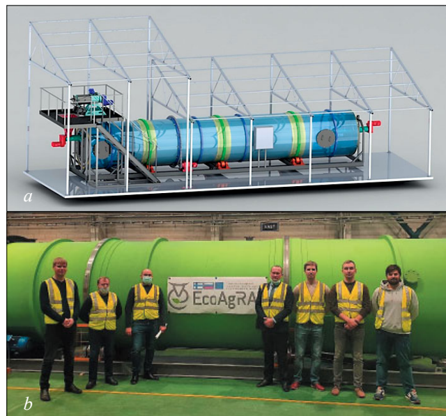
Рис. 2. Внешний вид установки BIOFERM 10.0 : а – 3D-модель; б – промышленный образец (изготовлен совместно с ООО «Научно-производственный центр «ОКАН»)
