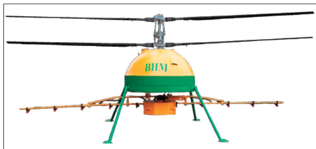
Рис. 2. Общий вид БВС-137 ВИМ на базе беспилотного вертолета Ка-137
