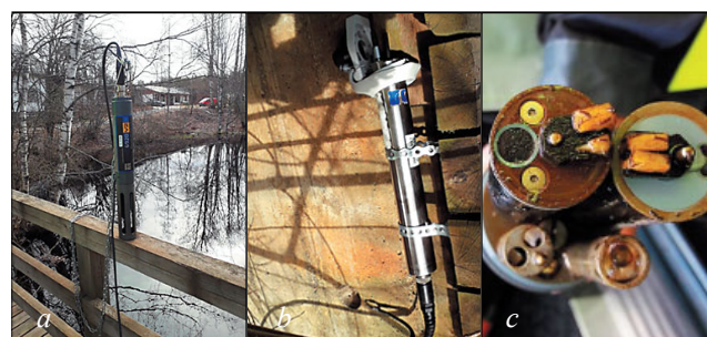
Рис. 3. Водный зонд YSI 6920 V2: а – общий вид; б – передатчик; в – измерительные датчики
