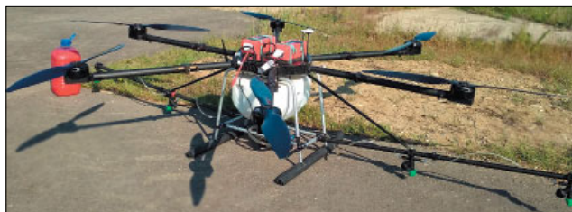
Рис. 2. Внешний вид гексакоптера ODONATA (тип 2, полезная нагрузка 10 кг)
