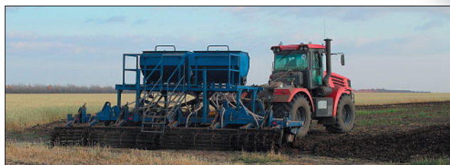
Рис. 3. Агрегат, состоящий из трактора «Кировец» К-744Р2 и культиватора-удобрителя, оборудованного системой ДВУ Fig. 3. A unit consisting of the Kirovets K-744R2 tractor and a cultivator-fertilizer equipped with a differentiated fertilization system
