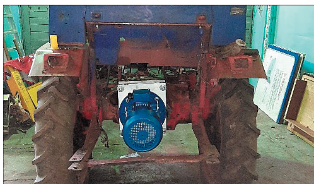
Рис. 2. Экспериментальный образец тракторного самоходного шасси Т-16 с электроприводом
