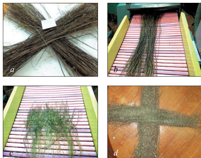
Рис. 1. Вид сырья и волокна при переработке в СМТ-500: а – горсти тресты; б – горсти на питающем транспортере; с – длинное волокно из тресты типов 5 и 6; d – длинное волокно из тресты 1-4
