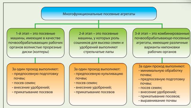
Рис. 1. Классификация многофункциональных посевных агрегатов
