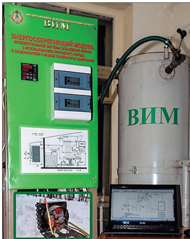
Рис. 3. Энергосберегающий модуль для охлаждения молока на фермах с использованием природного холода и экологически безопасных хладоносителей с низкой температурой заморозания
