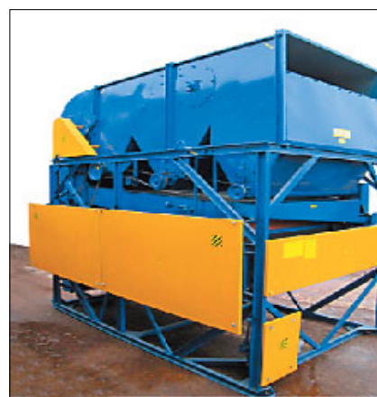
Рис. 2. Конструктивно-технологическая схема (а) и общий вид машины первично-вторичной очистки МЗУ-20Д (б):
