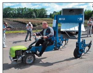
Рис. 15. Адаптер АП-1,5 с мотоблоком для работ в питомниках
