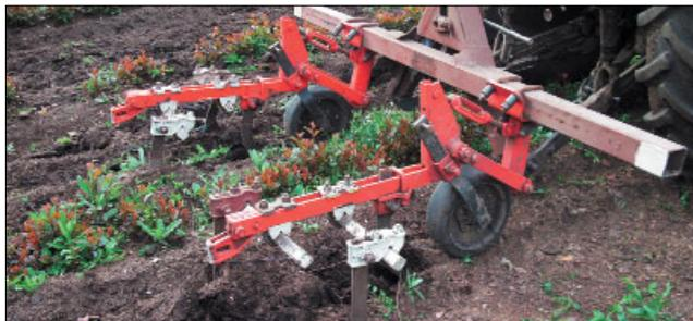
Рис. 3. Машина для междурядной обработки маточника UKM-MO
