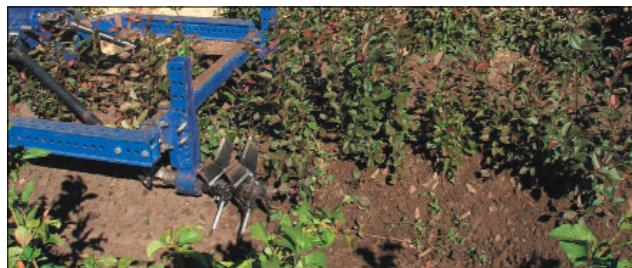
Рис. 2. Машина для окучивания отрастающих побегов в отводковом маточнике УКМ-О
