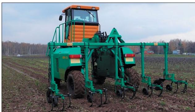
Рис. 11. Широкозахватный пропашной высококлиренсный культиватор
