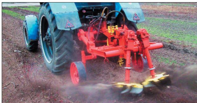
Рис. 1. Универсальный комплекс для весеннего раскрытия маточника УКМ-ВО
