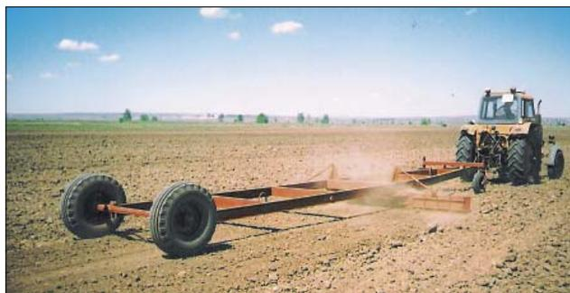
Рис. 4. Выравниватель полунавесной ВП-4.0
