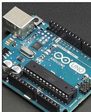
Рис. 3. Плата Arduino Uno
