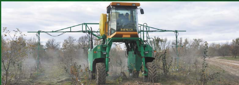
Адаптивная высокоточная машина экологически безопасного внесения жидких минеральных удобрений и химических средств защиты насаждений в пристовольную зону с микропроцессорным пультом управления
