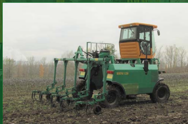
Высоклиренсное энергетическое средство с пропашным культиватором для междурядной обработки почвы
