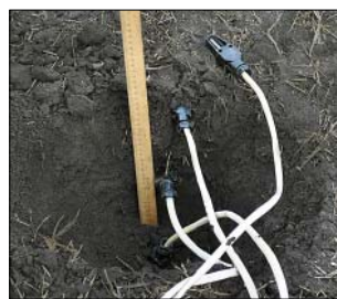
Рис. 2. Закладка температурных датчиков в пахотный горизонт
