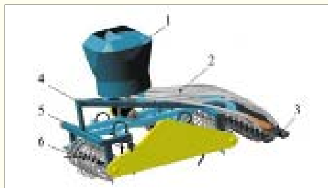
Рис. 1. Высевальный аппарат на базе блочно-модульного комбинированного адаптера:
