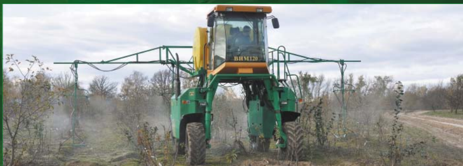
Адаптивная высокоточная машина экологически безопасного внесения жидких минеральных удобрений и химических средств защиты насаждений в приствольную зону с микропроцессорным пультом управления
