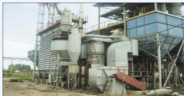
Рис. 2. Топочный блок ТБР-2,0 с сушилкой СЗТ-30
