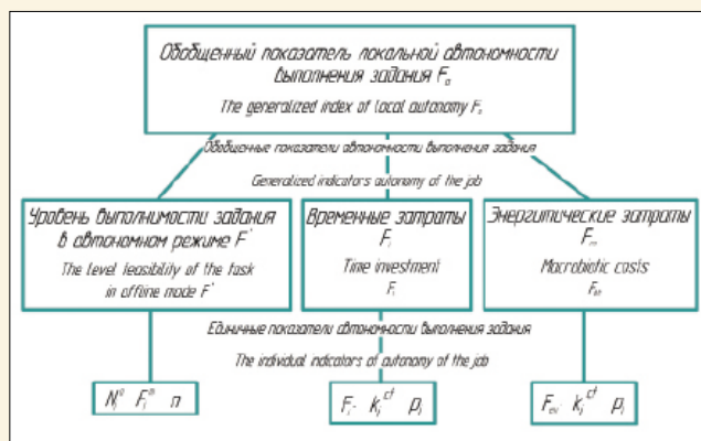
Рис. 7. Схема показателей автономности робототехнического средства
