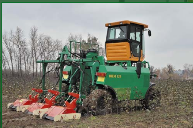
Высоклиренсное энергетическое средство с гидрофицированным ротационным рыхлителем для междурядной обработки почвы
