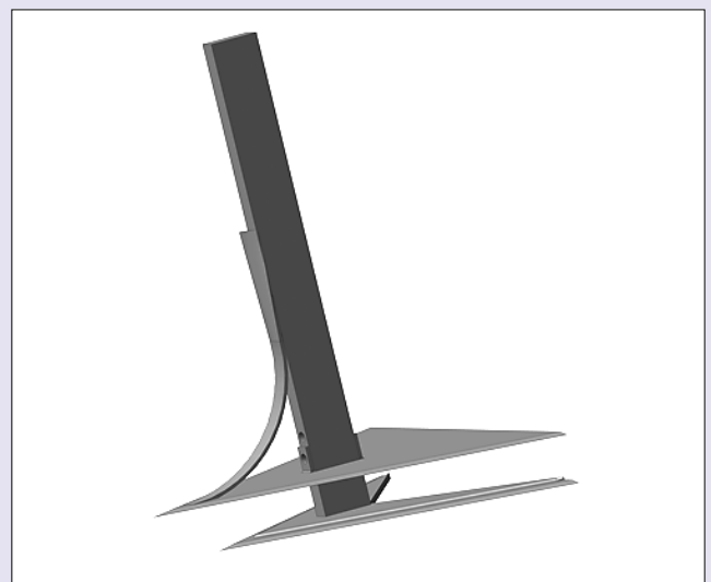
Рис. 2. 3D-модель двухъярусной почвообрабатывающей лапы Fig. 2. Double-level V-shaped cultivator tine. 3D model
