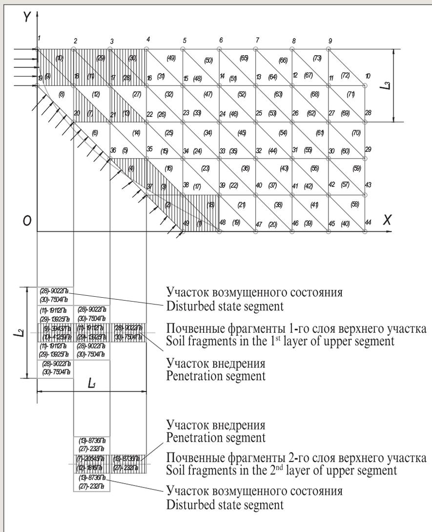
Рис. 3. Области возможного разрушения деформируемого слоя
