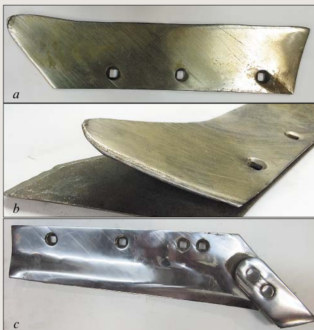
Рис. 6. Вид лемехов при пахоте тяжелосуглинистых почв (Владимирская МИС):
