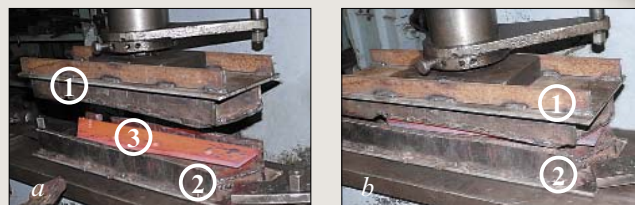
Рис. 3. Штамповка лемеха: а – положение перед работой; б – момент прижатия пуансона к матрице с заготовкой лемеха: 1 – пуансон; 2 – матрица; 3 – лемех
