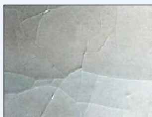
Рис. 3. Внешний вид образца ПЛА после воздействия 50 ч УФ (254 нм)
