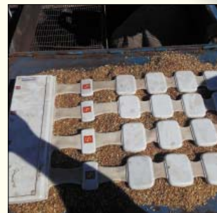
Рис. 2. Пакет излучателей аппарата «АЛМАГ-02» в развернутом положении
