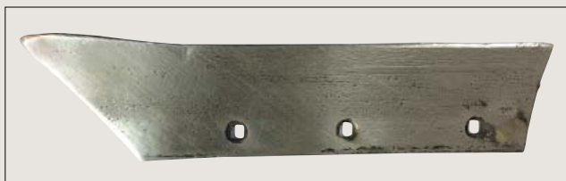
Рис. 2. Серийный долотообразный лемех П702
