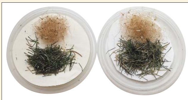
Рис. Корневая система и зеленая масса проросшей пшеницы на материале из ПГБ (слева) и ПГБ–СКН (справа)
