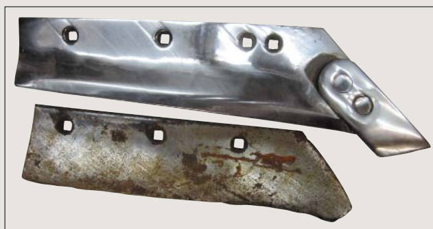
Рис. 4. Лемеха после испытаний: опытный лемех при наработке 15 га пригоден к дальнейшей эксплуатации (вверху); серийный лемех П702 при наработке 4,7 га достиг предельного износа (внизу)
