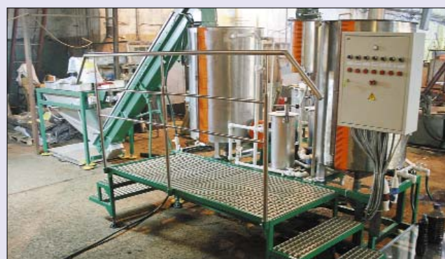
Рис. 2. Технологическая линия для приготовления комплексных удобрений на основе гуминовых в производственном цехе на испытаниях
