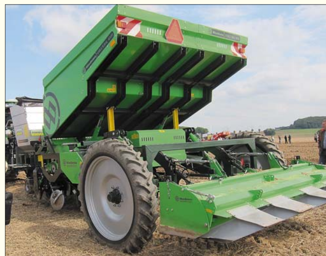
Рис. 8. Картофелесажалка с тросовым высаживающим аппаратом
