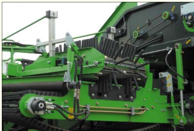
Рис. 13. Механический роторный отделитель почвенных комков и камней, установленный на комбайн
