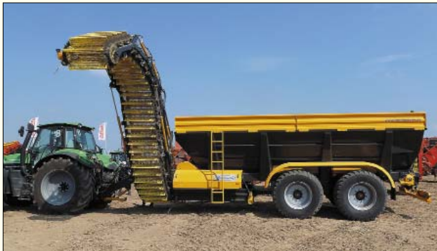
Рис. 16. Прицеп Brettmeister K3 с выгрузным транспортером в передней части
