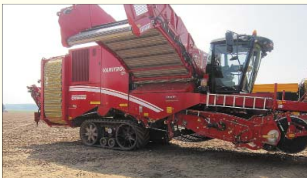
Рис. 10. Самоходный картофелеуборочный комбайн Varitron 470 фирмы Grimme
