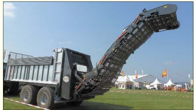
Рис. 17. Прицеп с выгрузным прутковым транспортером в задней части
