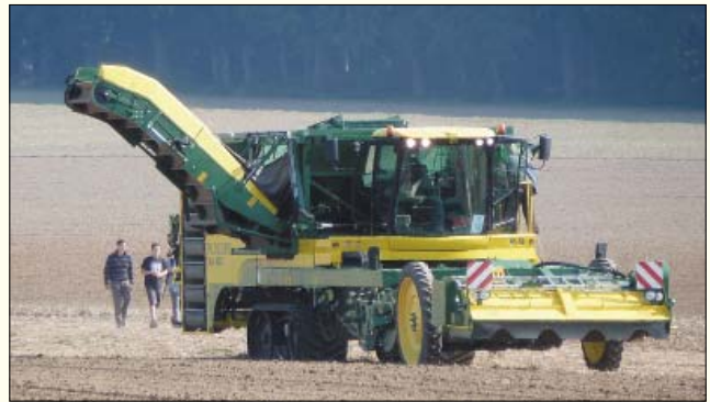
Рис. 11. Самоходный картофелеуборочный комбайн AR 4BX фирмы Ploeger
