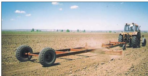
Рис. 4. Выравниватель полунавесной ВП-4.0
