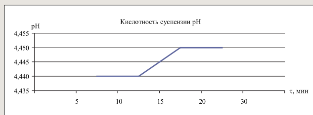
Рис. 3. Зависимость уровня кислотности гуминовых удобрений от времени воздействия кавитации на суспензию торфа
