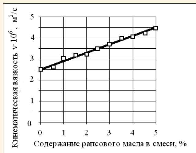
Рис. 1. Зависимость кинематической вязкости топлива от содержания рапсового масла (температура топлива 40°C, кинематическая вязкость чистого топлива 2,5·10 -6 м 2 /с, кинематическая вязкость рапсового масла 41,2·10 -6 м 2 /с)
