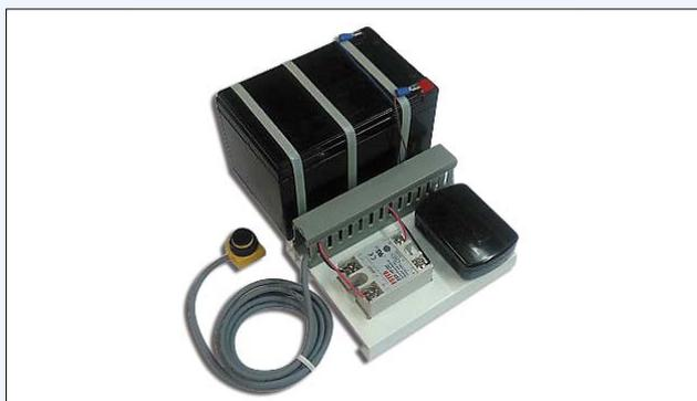
Рис. 1. Испытуемый блок сбора и передачи данных СМСК
