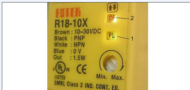
Рис. 2. Светодиодный индикатор заполнения сменного кузова: 1 – индикатор питания; 2 – индикатор заполнения
