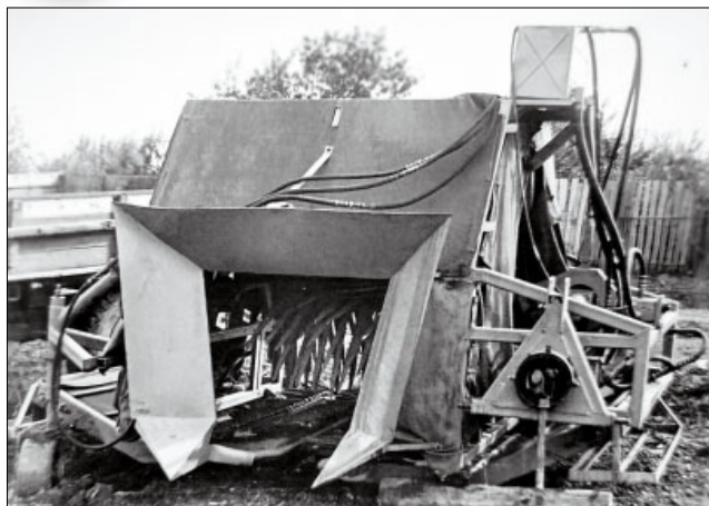
Рис. 5. Установка ПЯМ-70 и ее рабочие органы (активатор, центральный приемник и выносные транспортеры)
