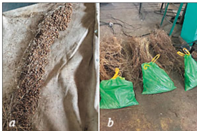
Рис. 5. Очесанный льноворох из бункера (а), стебли после очеса и отсортированный ворох (б) Fig. 5. Combed flax material discharged from the hopper (a); flax stems after combing and sorted material (b)
