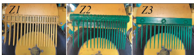
Рис. 3. Гребенки очесывающего устройства с зубьями разной формы: Z1 – прямоугольные; Z2 – ромбические; Z3 – круглые
