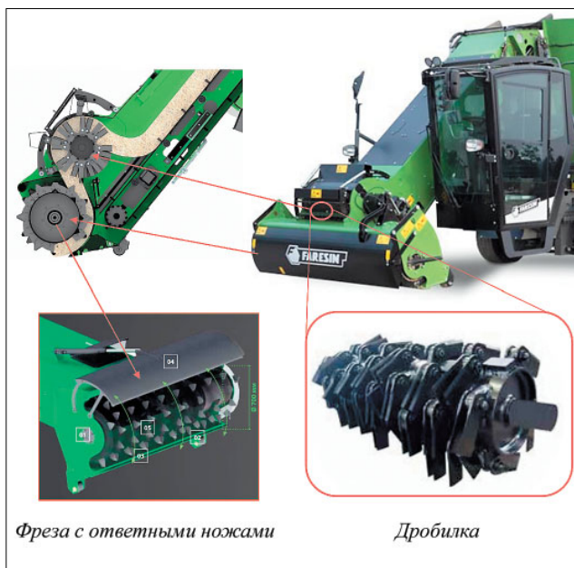
Рис. 7. Фреза с дробилкой самоходного смесителя-кормораздатчика Faresin модели PF. Источники: https://www.faresin.com/ru , каталоги техники для животноводства фирмы Faresin Industries
