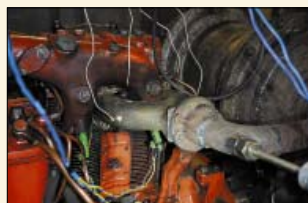
Рис. 1. Система с обратной связью; зеленые – водные форсунки во впускном коллекторе; белые – датчики в выпускном коллекторе
