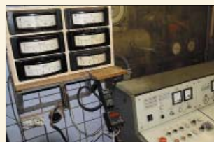
Рис. 2. Измерительный стенд с приборным щитком для снятия показаний с измерительных головок
