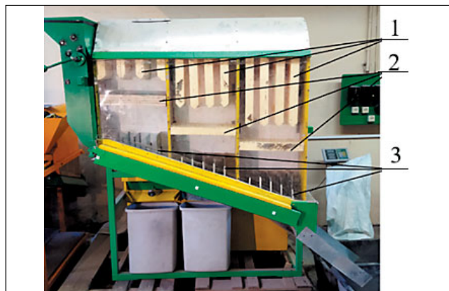
Рис. 1. Расположения ускорителей и рассекателей в пневмоканалах макетного образца: 1 – колонковый ускоритель; 2 – батарейный ускоритель; 3 – рассекатели Fig. 1. Arrangement of accelerators and deflectors in the pneumatic channels of the prototype: 1 – column-type accelerator; 2 – battery-type accelerator; 3 – deflectors
