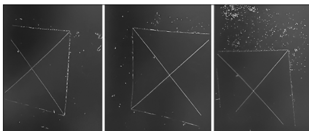
Рис. 3. Захват обработанного видеопотока с помощью детектора Canny с сенсором PMW3901
