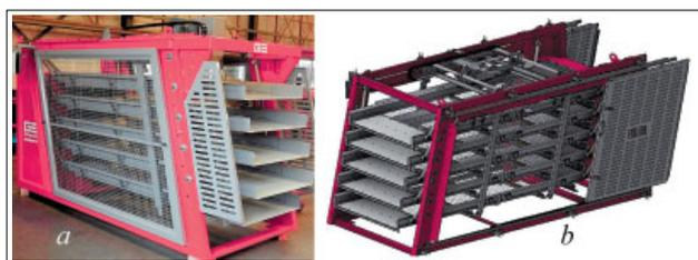
Рис. 1. Калибровочная машина *Tolsma*
