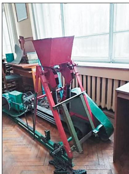
Рис. 1. Лабораторная установка для определения качества работы высеивающих аппаратов
